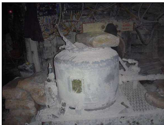
Fotografía B.2: Equipo para la dispersión de agente inertizante. Mina Bobrek (Polonia)
